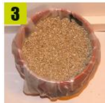
3 Mettre la vermiculite jusqu'à recouvrir toutes les batteries. Bien mettre une couche épaisse sur le dessus, voir jusqu'en haut du fût.
