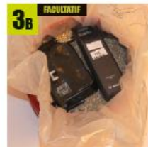
3B FACULTATIF Couche de batterie en plus Si vous avez suffisamment de place, vous pouvez mettre quelques batteries supplémentaire au dessus - puis recouvrir de vermiculite jusqu'en haut du fût.
