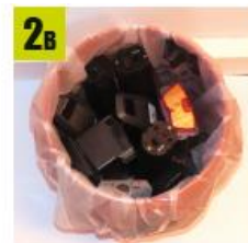
2 Ranger les batteries verticalement dans le fût > selon les catégories entre 10 et 20 batteries entrent dans un fût.
