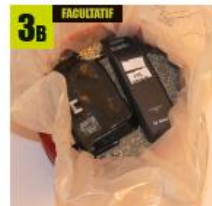
3B FACULTATIF Couche de batterie en plus Si vous avez suffisamment de place, vous pouvez mettre quelques batteries supplémentaire au dessus - puis recouvrir de vermiculite jusqu'en haut du fût.
