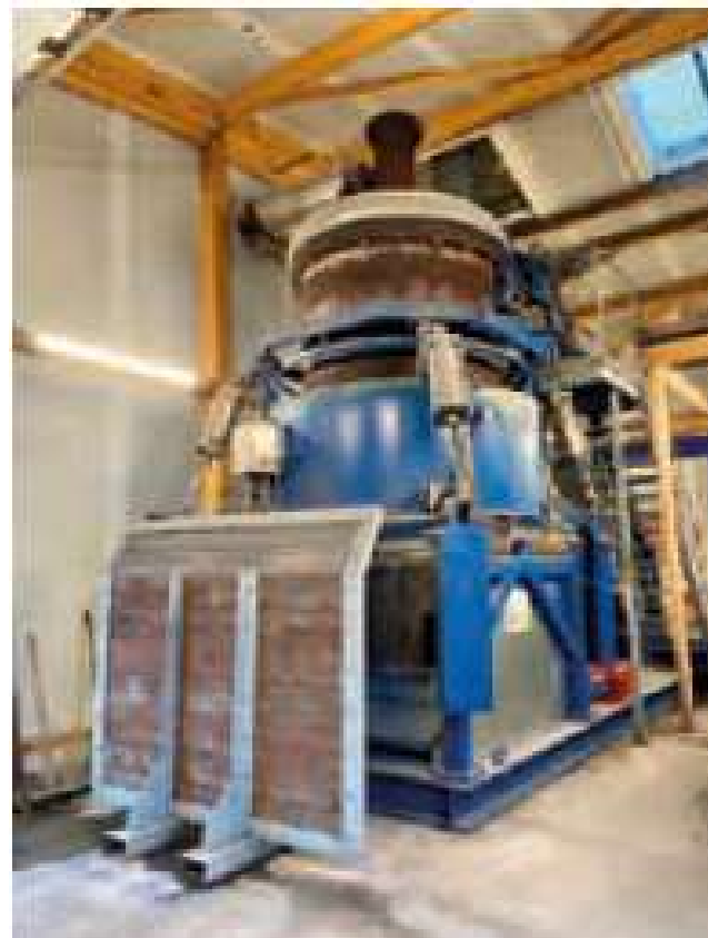
Unité de désensibilisation Autoliv/Livbag (Pont de Buis - 29) Valorisation matière de la partie métallique
